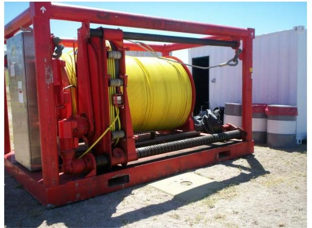
Winch con "kevlar" de comunicación y seguridad
