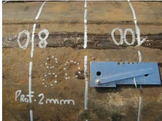
**A 0,80 a 0,90 metros a las 1:00 Horas (Área diámetro 2 centímetros) Profundidad máxima 2,0 milímetros.**
