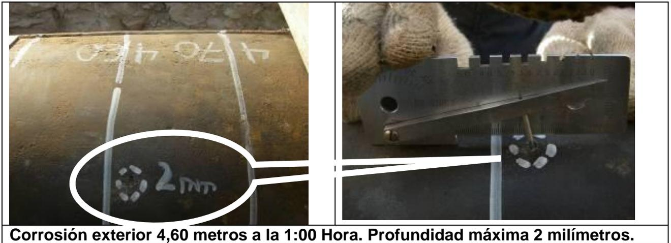
**Corrosión exterior 4,60 metros a la 1:00 Hora. Profundidad máxima 2 milímetros.**
